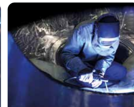
↑ Framatome, soudage sur un générateur de vapeur EPRT ©Nicolas De Lepierre/ Framatome
