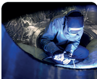
↑ Framatome, soudage sur un générateur de vapeur EPRT ©Nicolas De Lepierre/ Framatome
